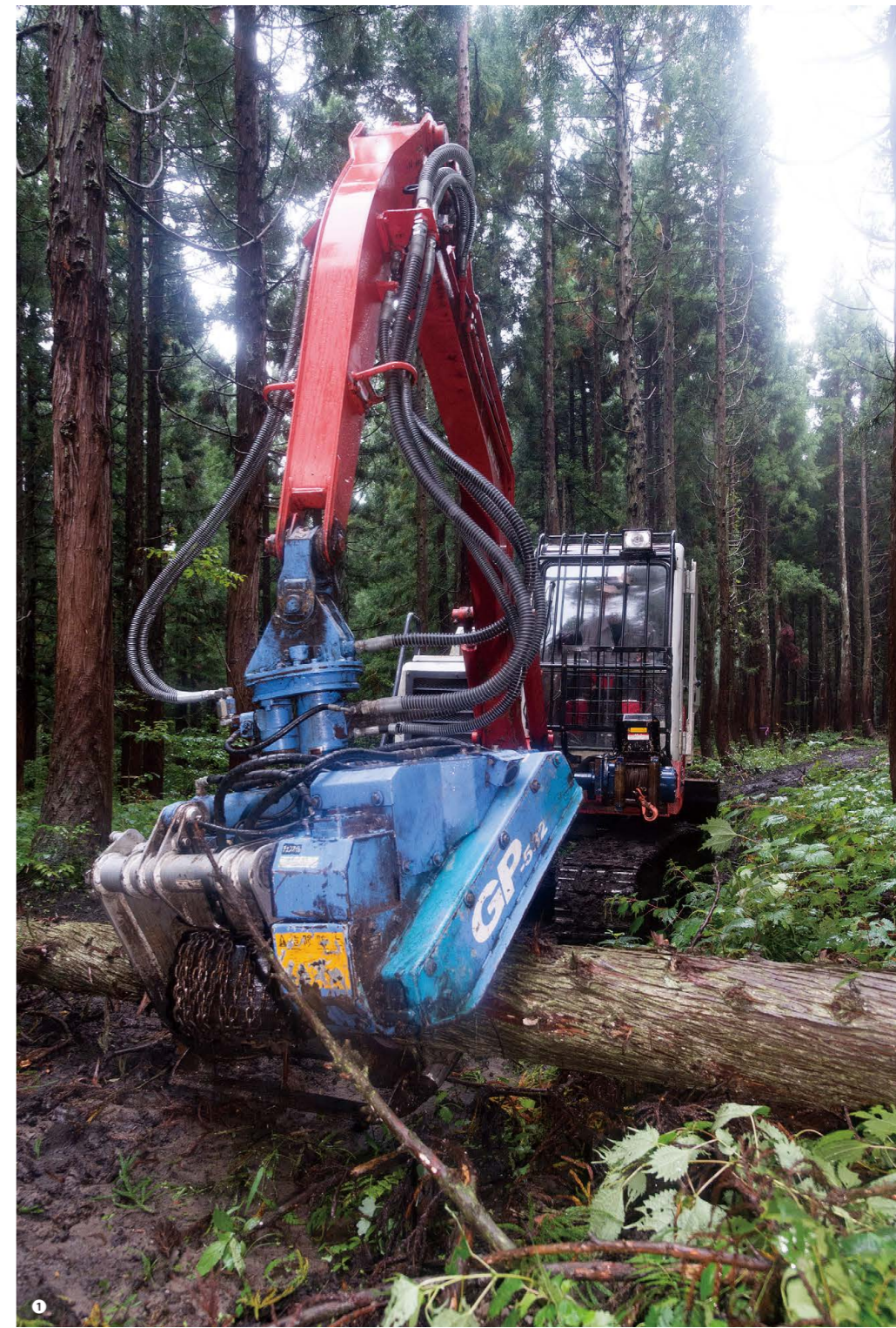
①プロセッサで伐倒した木を造材する。組合ではグラブ2台、フォワーダ2台を所有し、作業の効率化を図る ②プロセッサのオペレーターの八橋一樹さんは3年目。「思い通りに動かせる面白いです」 ③7.23ヘクタールの山の間伐と造材を大桃さんと八橋さん達だけで行うにはチームワークが大切 ④期待の新人2人をまとめる岡田さん。「今後は地元の材を地元で活用していきたい」
